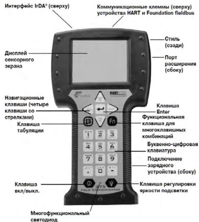
Рисунок D. Назначение элементов управления коммуникатора модели 375
